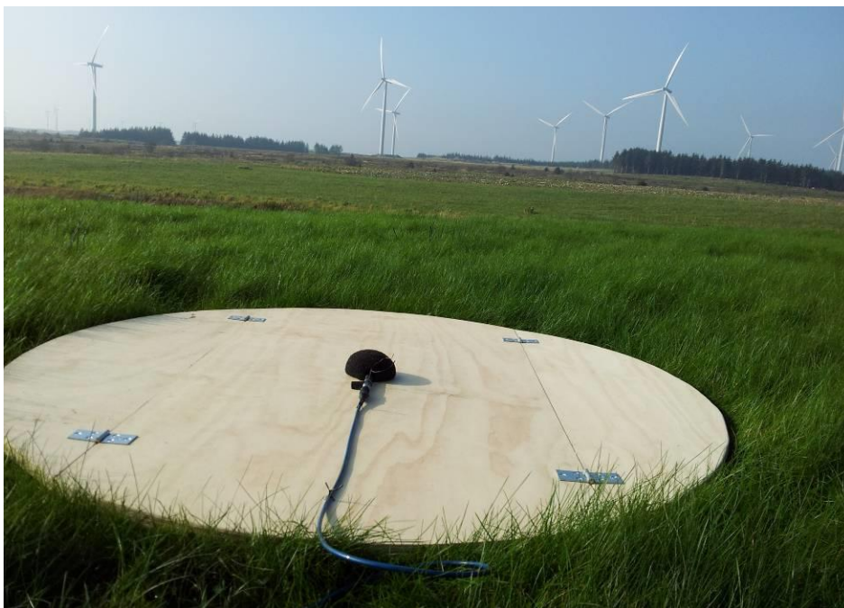
Figur 1: Mikrofonplassering på måleplate (bildet er tatt under måling ved en annen vindmøllepark)
